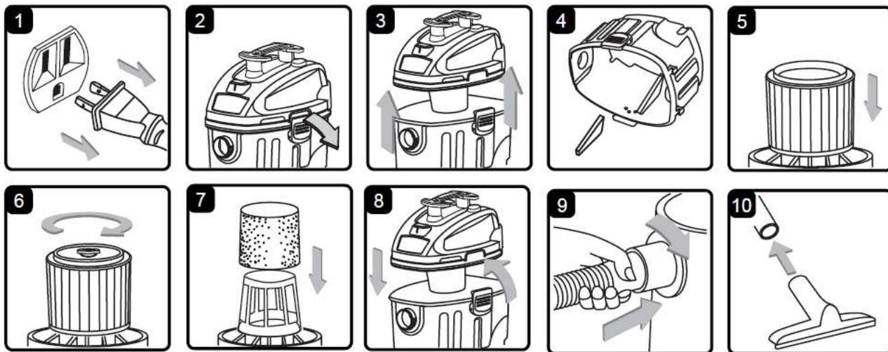
**WARNING: DO NOT PLUG IN POWER CORD TO POWER OUTLET, MAKE SURE PLUG IS DISCONNECTED BEFORE ASSEMBLING THE WET/DRY VAC.**
